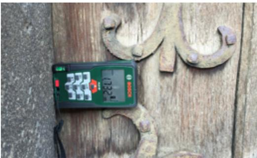
La véritable porte d'entrée de St Diéry, mesurant, quant à elle  $173,2\text{ cm} \pm 0,2$  de large pour une hauteur de  $273,2 \pm 0,3\text{ cm}$ . Soit  $\sqrt{3}$  exprimé en mètre pour la largeur et  $\sqrt{3} + 1$  pour la hauteur de cette
