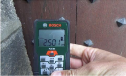
La largeur de la porte d'entrée nord est de 250 cm  $\pm 0,2$ . La hauteur de cette dernière est de 432,7 cm  $\pm 0,2$ . Ces deux dimensions délivrent le 1/2 mètre et le 1/3 de mètre.
